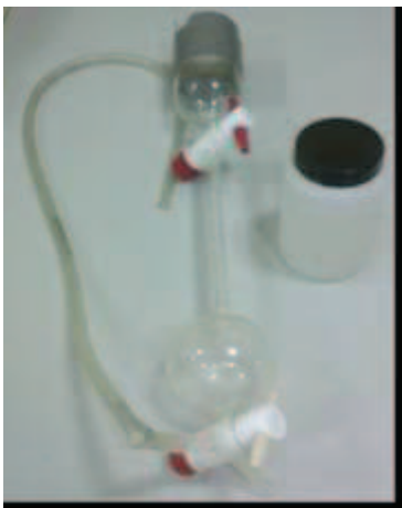
Fig. 2. Bureta speciale për matjen e pastërtisë së \text{CO}_2
