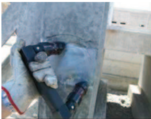
Figura 1. NDT me pjesëza magnetike
