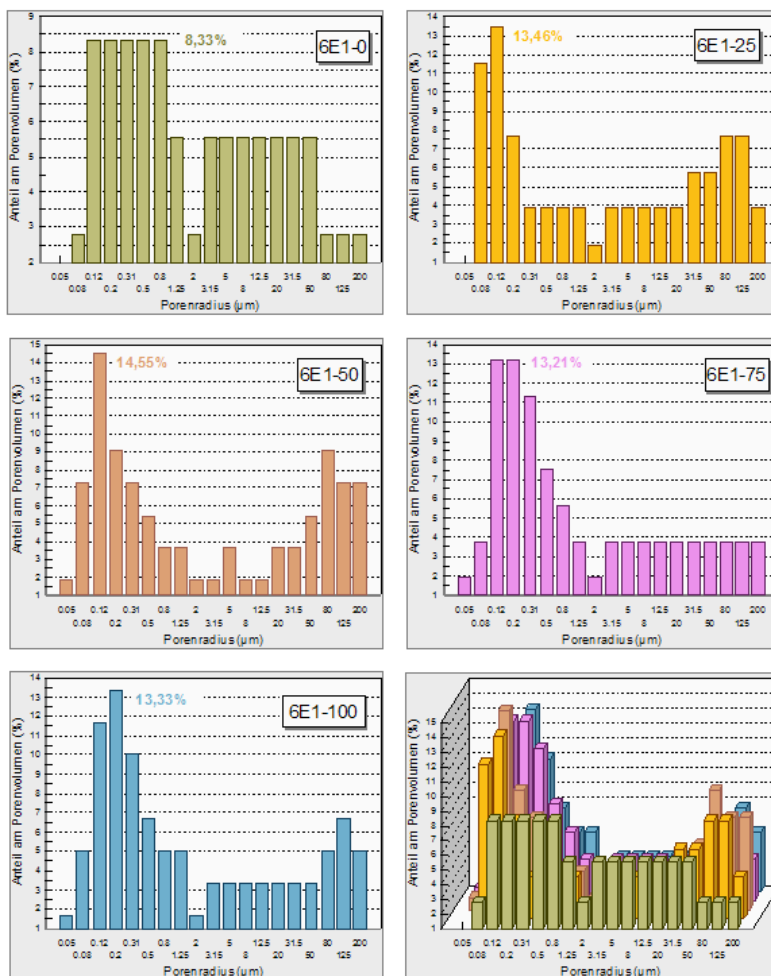
Diag. 1: Shpërndarja e rrezeve të poreve në serinë e cikleve ndërruese ngrirje – shkrije në provën 6E1: 0; 25; 50; 75 dhe 100 –numri i cikleve Porenradius –Rrezet e poreve Anteil am Porenvolumen – Pjesëmarrja në vëllimin e poreve
